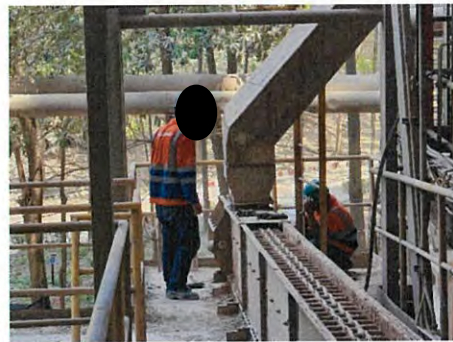
4. งานเช็คเปลี่ยน Bearing drag chain Y62-CV3 (ลุนถวิล)
