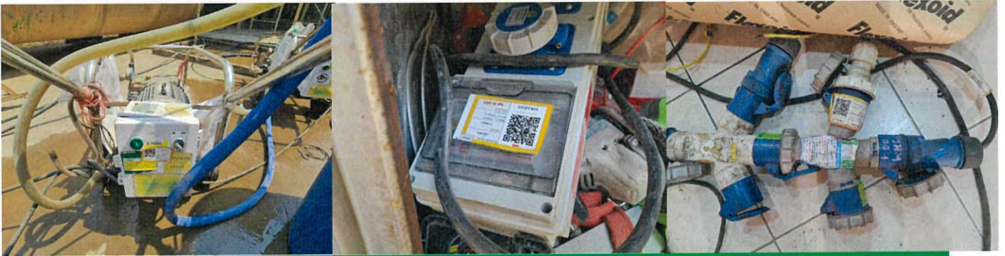
อุปกรณ์และเครื่องมือไฟฟ้าของผู้ปฏิบัติงานได้รับการตรวจสอบและมีสติกเกอร์รับรอง
